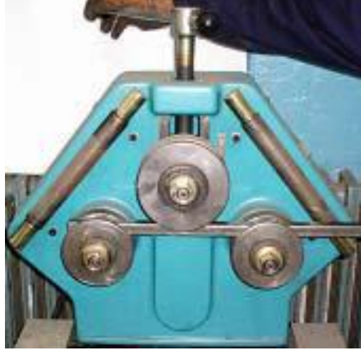
Şekil 3.6 İş parçasının merdaneye bağlanması.
