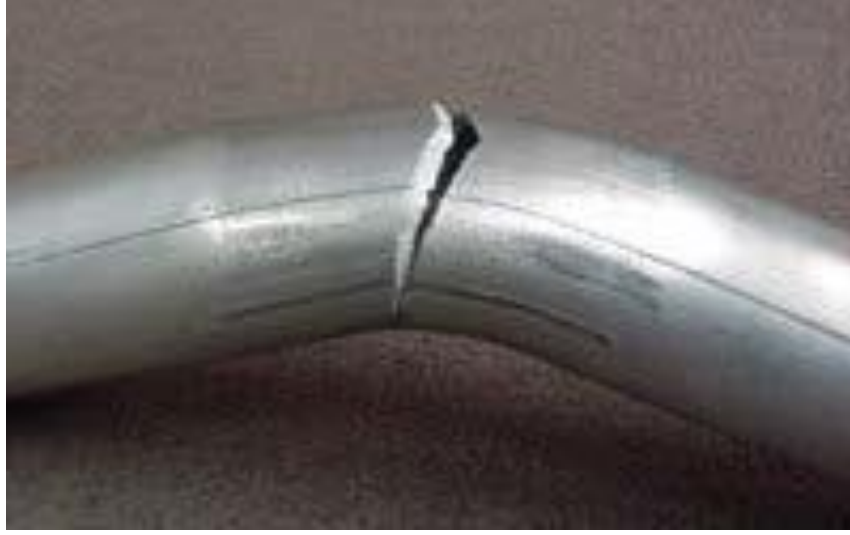
Şekil 4.1. Bükme sonrasında kırılan boru
