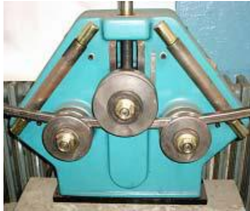
Şekil 3.7. İş parçasının bükmeye başlaması
