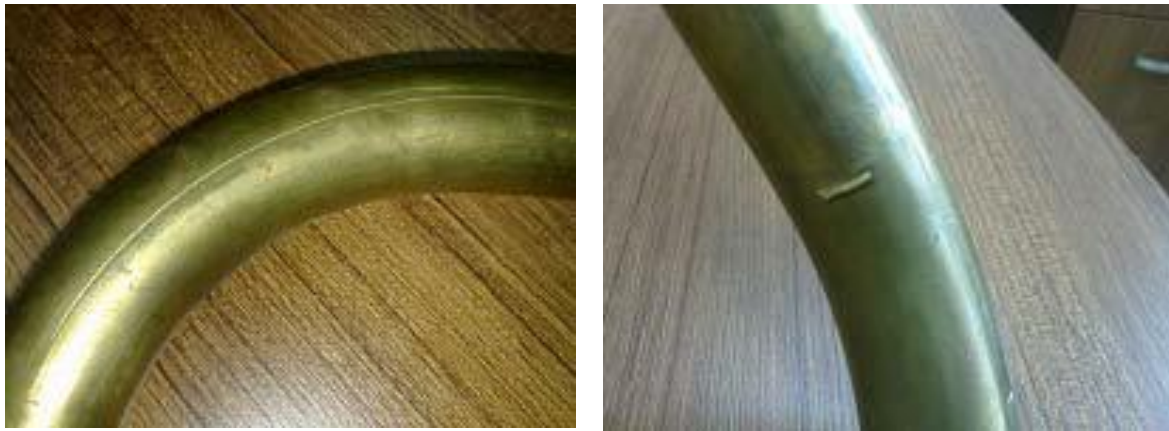
Şekil 4.5. Yüzey pürüzlülüđü bozulmuş boru
