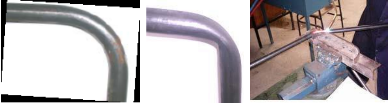
Şekil 2.16. Doğru büküm, Hatalı büküm, Kalıpta bükme
