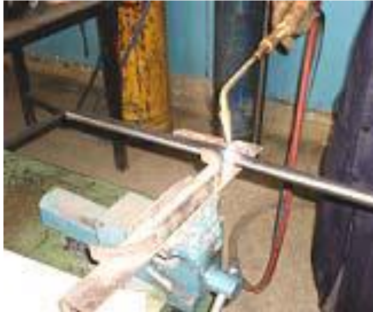
Şekil 2.15. Bükülecek kısmın ısıtılması
