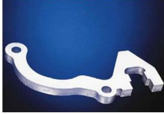
Şekil 3.10 Azot gazı ile kesilmiş parça
