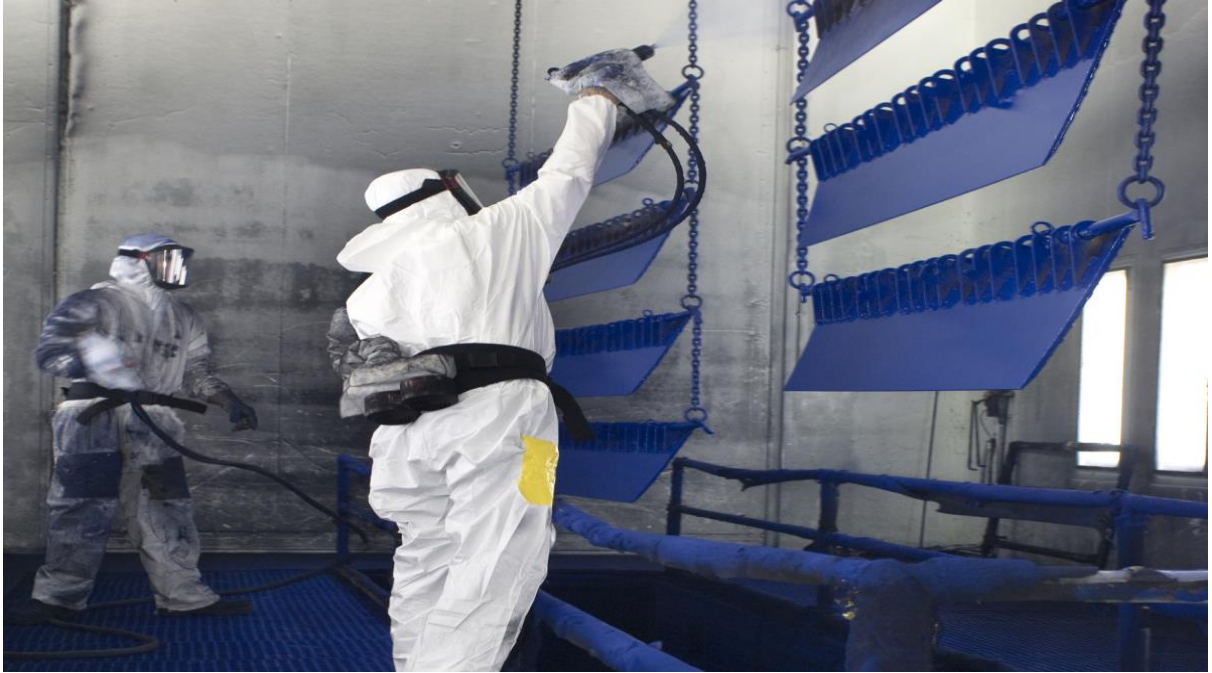
Şekil 3.6 Manuel Toz Boya Uygulaması
